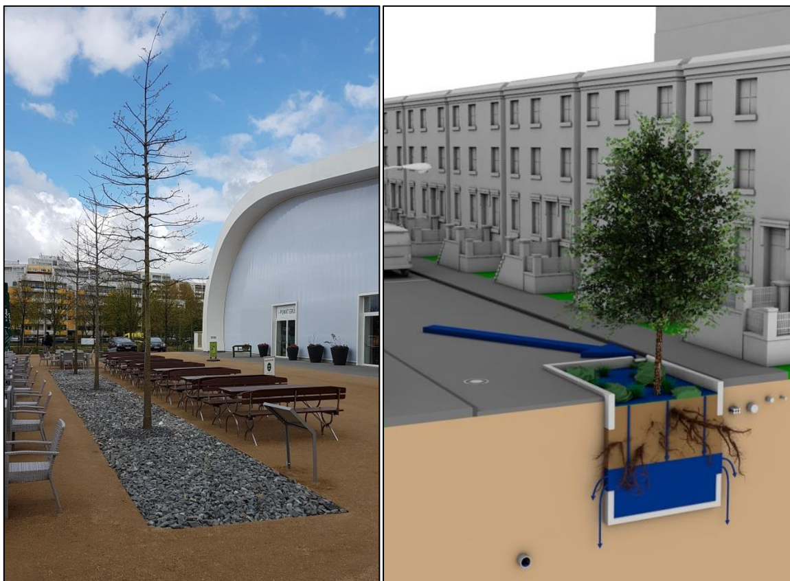
Abbildung 12: Baum-Rigole in den Gärten der Welt (links) und Konzeptdarstellung (rechts) [Quelle: IPS 2019]
