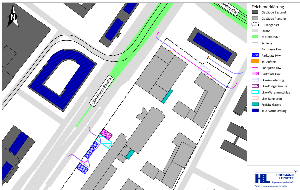
Abbildung 4-2 Lage der Schallquellen zum Anlagenlärm
