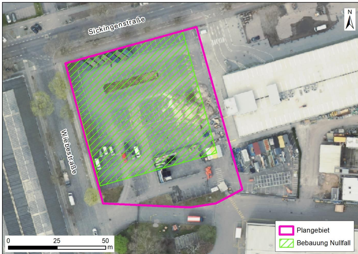
Abb. 3.1: Darstellung der angenommenen Bestandsbebauung im Nullfall auf Grundlage des geltenden Baurechts (Höhe 20 m). Kartenhintergrund: WMS DOP 2024
