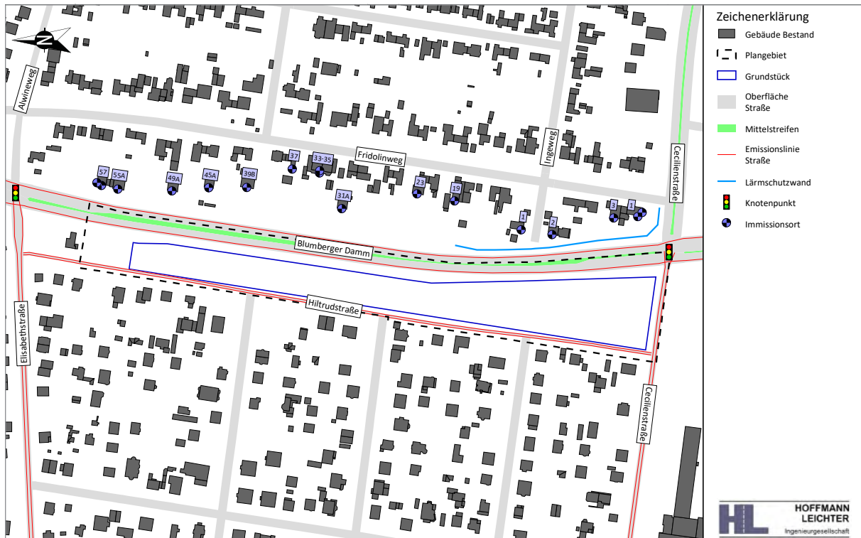
Abbildung 4-2 Lage der Schallquellen zum Straßenverkehrslärms
