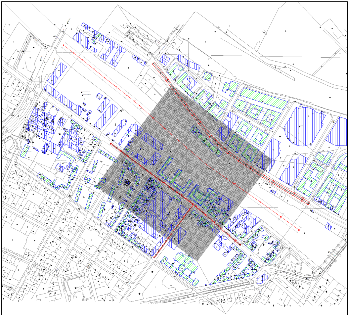
Abbildung 27: Lageskizze des MISKAM-Rechengebiets für den Prognoseplanfall (inneres Rechengebiet: grau schraffierte Fläche; äußeres Rechengebiet: äußeres Rechteck, Norden oben)
