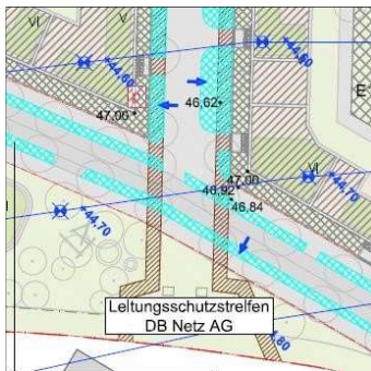
Abbildung 31: Ausschnitt Leitungsschutzstreifen DB im Plangebiet, Regenwassergrobkonzept [A8]
