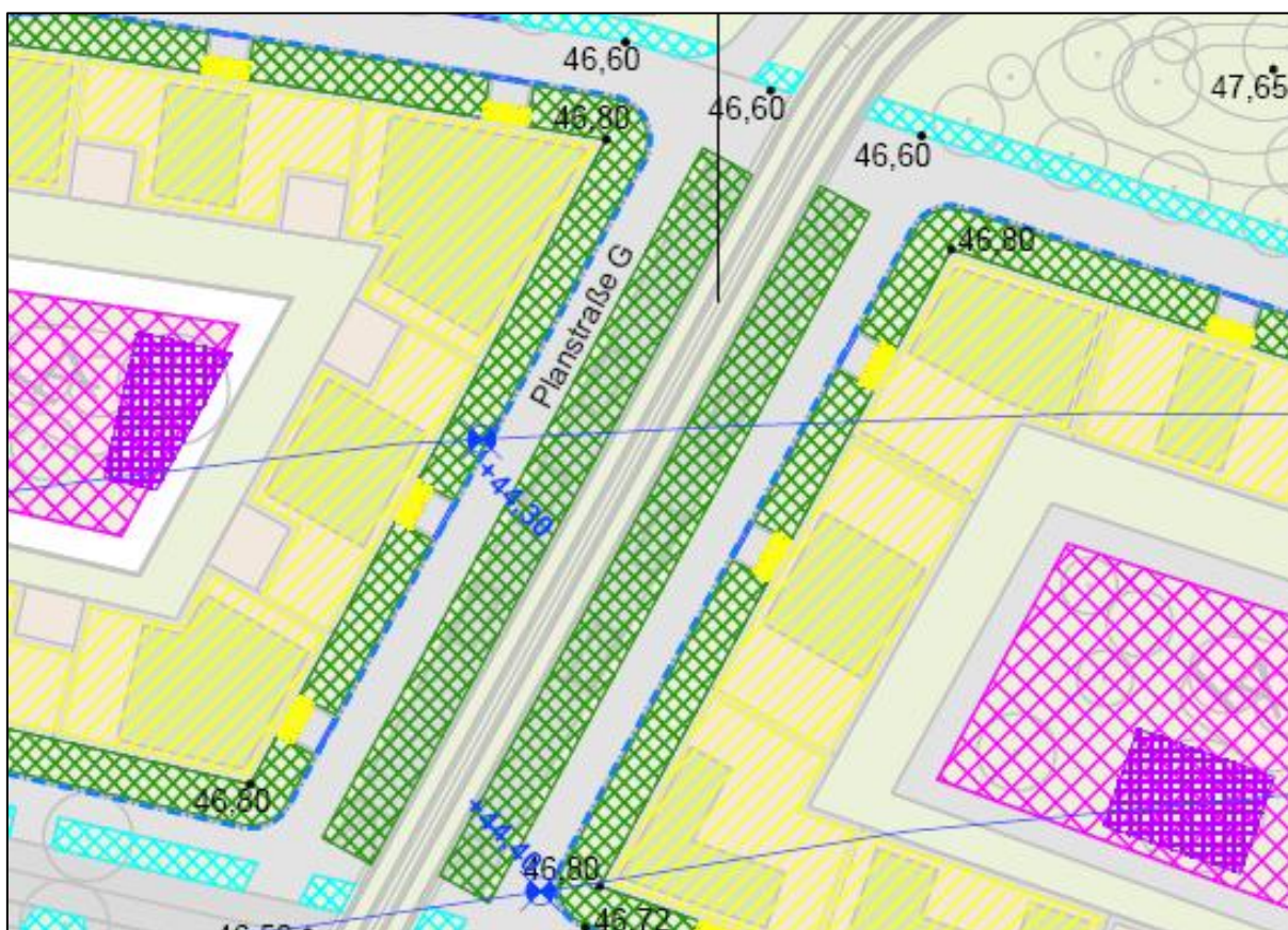
Abbildung 14: Flächenversickerung in Vorhaltefläche der Tramstation, Planstraße G
