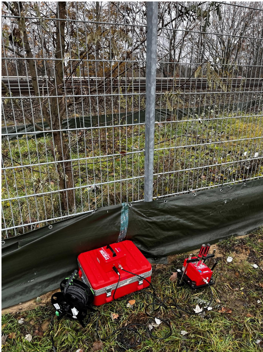
Abbildung 1: Ankopplung des Schwingungsmesssystems SYS22 über einen Erdspeiß an den Boden am MP1 während des Messtermins vom 30.11. - 02.12.2022 (Blickrichtung nach Norden; Gleisanlagen im Hintergrund; Entfernung zu den Gleisanlagen: ca. 10 m)
