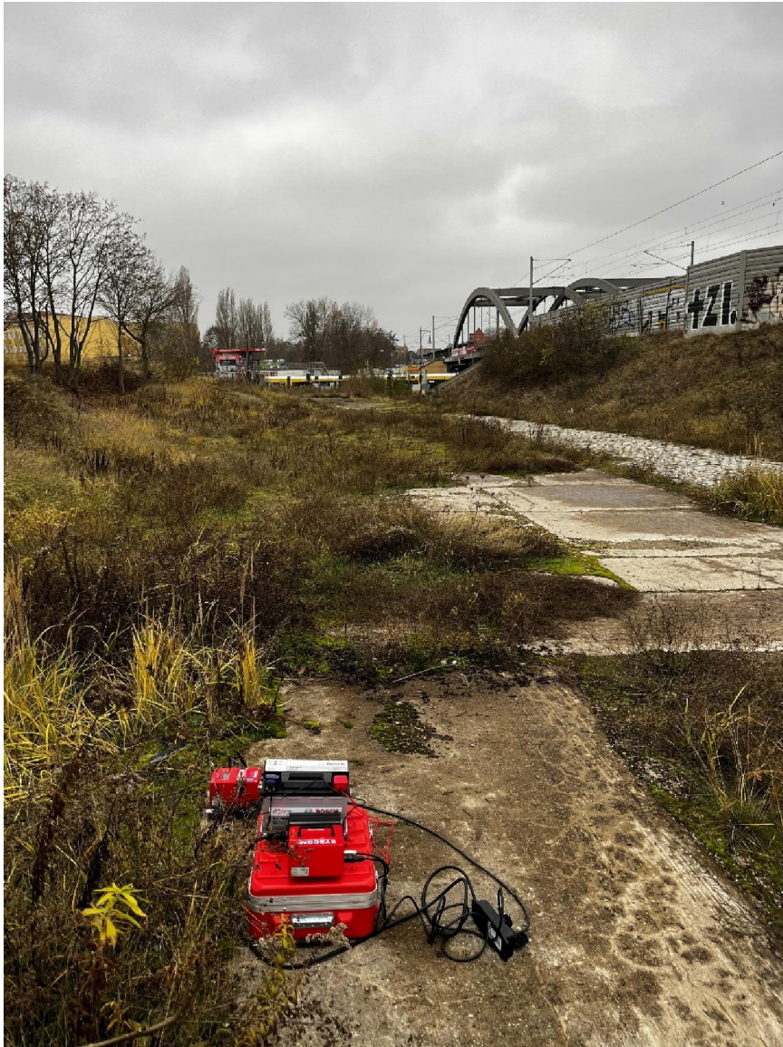
Abbildung 5: Positionierung des Schwingungsmesssystems SYS20 auf weitläufigen Betonplatten am MP5 während des Messtermins vom 30.11. - 02.12.2022 (Blickrichtung nach Südwesten; Gleisanlagen mit Schallschutzwand rechts im Bild, Gelände des Infopavillons / Berliner Straße im Hintergrund; Entfernung zu den Gleisanlagen: ca. 23 m)
