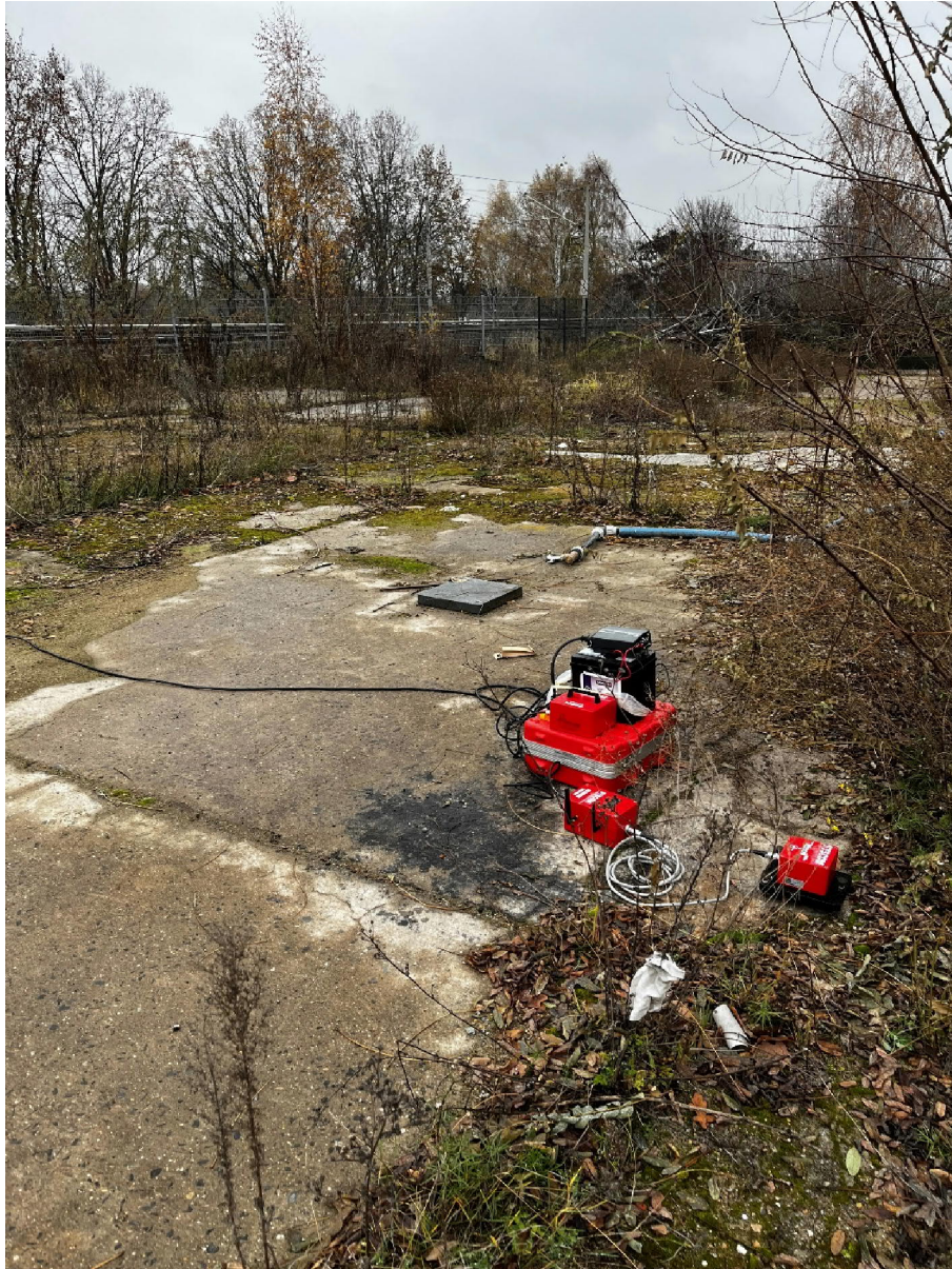
Abbildung 2: Platzierung des Schwingungsmesssystems SYS6 auf weitläufigen Betonplatten am MP2 während des Messtermins vom 30.11. - 02.12.2022 (Blickrichtung nach Norden; Gleisanlagen im Hintergrund; Entfernung zu den Gleisanlagen: ca. 30 m)
