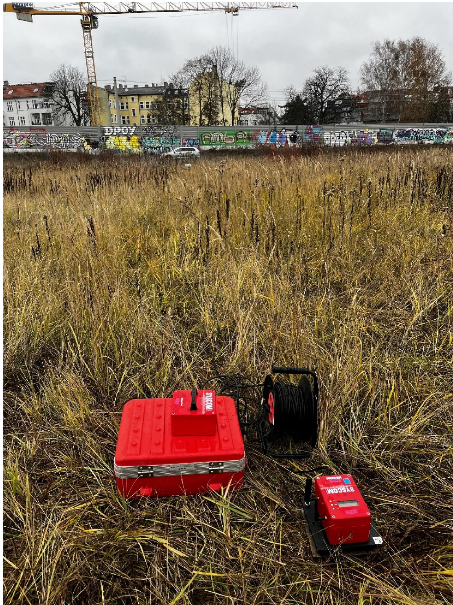
Abbildung 4: Ankopplung des Schwingungsmesssystems SYS19 über einen Erdspeiß an den Boden am MP4 während des Messtermins vom 30.11. - 02.12.2022 (Blickrichtung nach Nordwesten; Gleisanlagen mit Schallschutzwand sowie MP3 im Hintergrund; Entfernung zu den Gleisanlagen: ca. 65 m)
