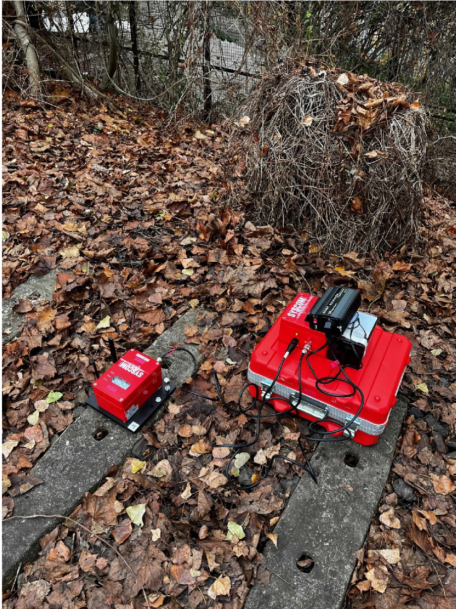
Abbildung 8: Positionierung des Schwingungmesssystems SYS26 auf Betonschwellen am MP8 während des Messtermins vom 30.11. - 02.12.2022 (Blickrichtung nach Südosten; Entfernung zu den Gleisanlagen: ca. 60 m)
