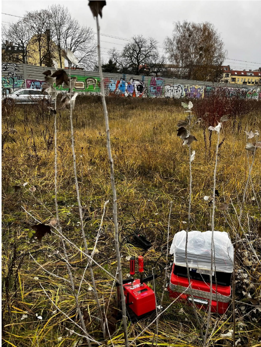
Abbildung 3: Ankopplung des Schwingungsmesssystems SYS18 über einen Erdspieß an den Boden am MP3 während des Messtermins vom 30.11 .- 02.12.2022 (Blickrichtung nach Norden; Gleisanlagen mit Schallschutzwand im Hintergrund; Entfernung zu den Gleisanlagen: ca. 35 m)
