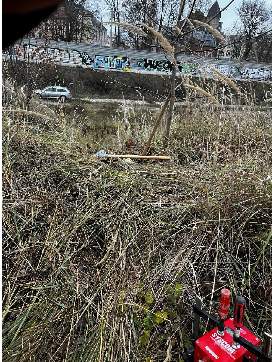
Abbildung 6: Ankopplung des Schwingungsmesssystems SYS21 über einen Erdspieß an den Boden am MP6 während des Messtermins vom 30.11. - 02.12.2022 (Blickrichtung nach Nordwesten; Gleisanlagen mit Schallschutzwand im Hintergrund; Entfernung zu den Gleisanlagen: ca. 50 m)
