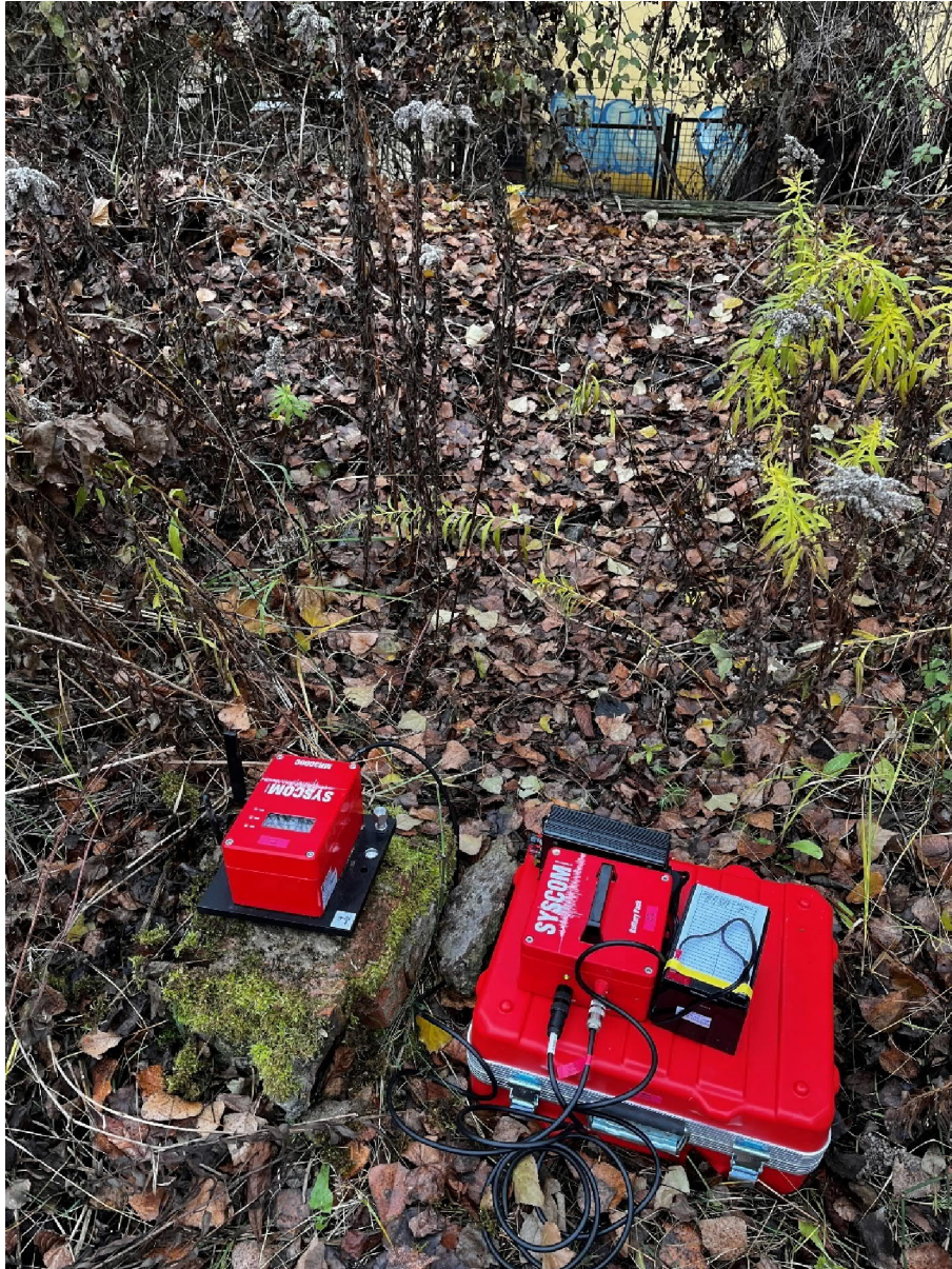
Abbildung 7: Positionierung des Schwingungsmesssystems SYS25 auf lokal vorhandenem Mauerwerk am MP7 während des Messtermins vom 30.11.-02.12.2022 (Blickrichtung nach Südosten; Entfernung zu den Gleisanlagen: ca. 60 m)
