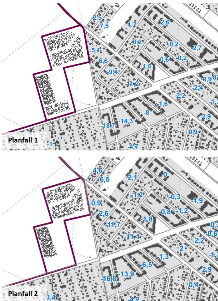
Abb. 4.7: Mittlere Abnahme des Kaltluftvolumens im Siedlungsraum pro Blockfläche in Prozentpunkten gegenüber dem Istzustand im Planfall 1 (oben) und Planfall 2 (unten)
