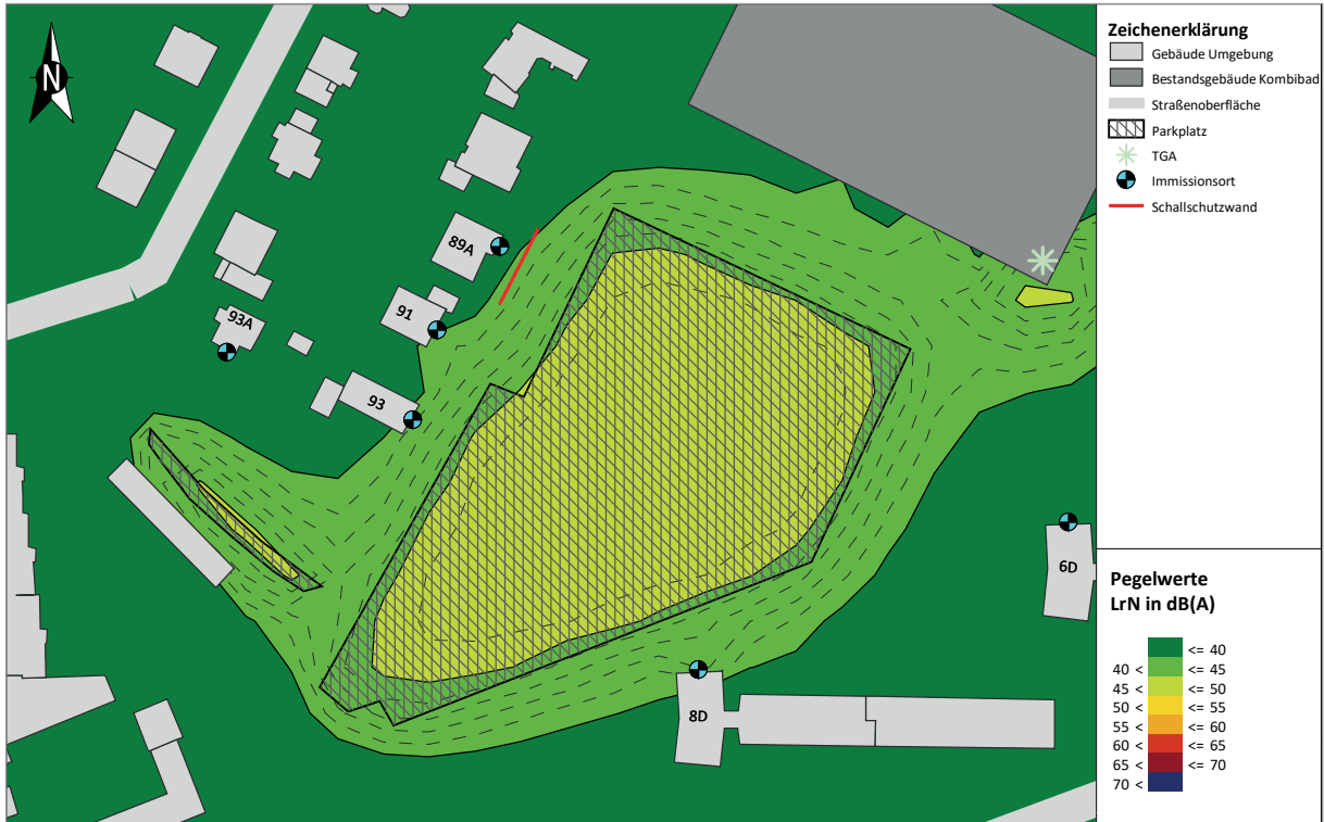
Abbildung 5-8 Isophonenkarte in 5 m Höhe über Gelände | Beurteilung nach Freizeitlärm-Richtlinie | sonn- und feiertags | nachts, 22:00 - 07:00 Uhr | Planvariante 1 | mit Schallschutzmaßnahmen
