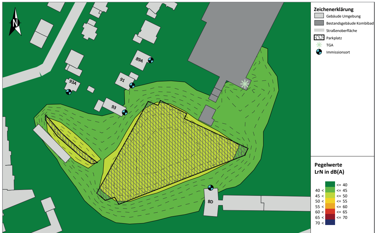
Abbildung 5-2 Isophonenkarte in 5 m Höhe über Gelände | Beurteilung nach Freizeitlärm-Richtlinie | sonn- und feiertags | nachts, 22:00 - 07:00 Uhr | Bestand
