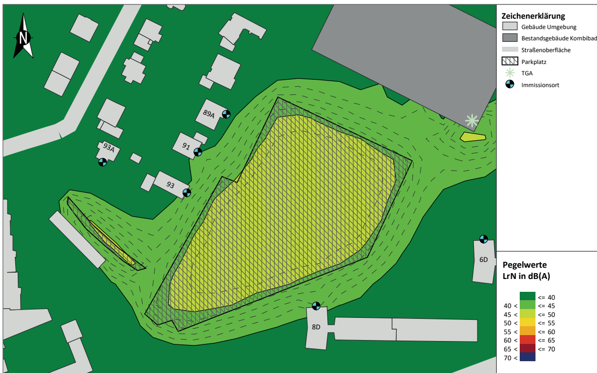
Abbildung 5-4 Isophonenkarte in 5 m Höhe über Gelände | Beurteilung nach Freizeitlärm-Richtlinie | sonn- und feiertags | nachts, 22:00 - 07:00 Uhr | Planvarianten 1 bis 3
