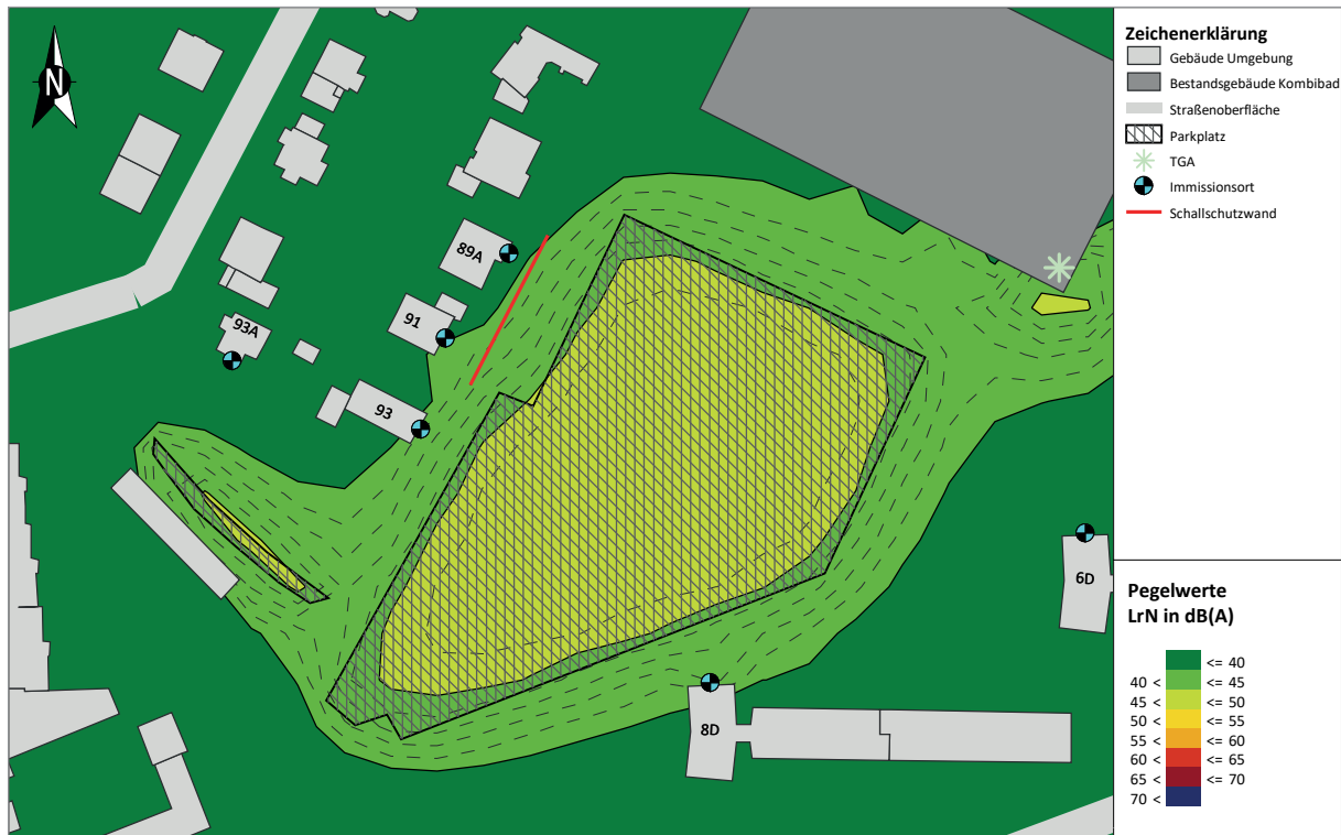
Abbildung 5-12 Isophonenkarte in 5 m Höhe über Gelände | Beurteilung nach Freizeitlärm-Richtlinie | sonn- und feiertags | nachts, 22:00 - 07:00 Uhr | Planvariante 3 | mit Schallschutzmaßnahmen
