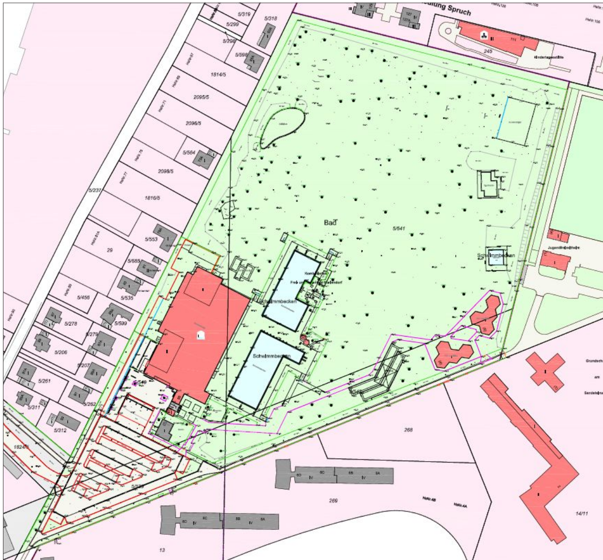
Abbildung 2: Übersichtsplan des bestehenden Kombibades mit Gebäuden (rot), Becken (blau), Parkplatz (graugelb) und Vegetationsfläche (grün)
