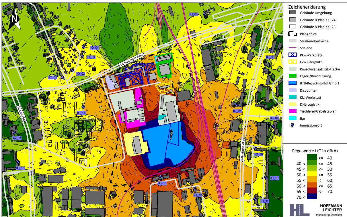
Abbildung 5-3 Isophonenkarte in 5 m Höher über Gelände | Beurteilung nach TA Lärm | Zusatzbelastung | tags, 06:00 - 22:00 Uhr
