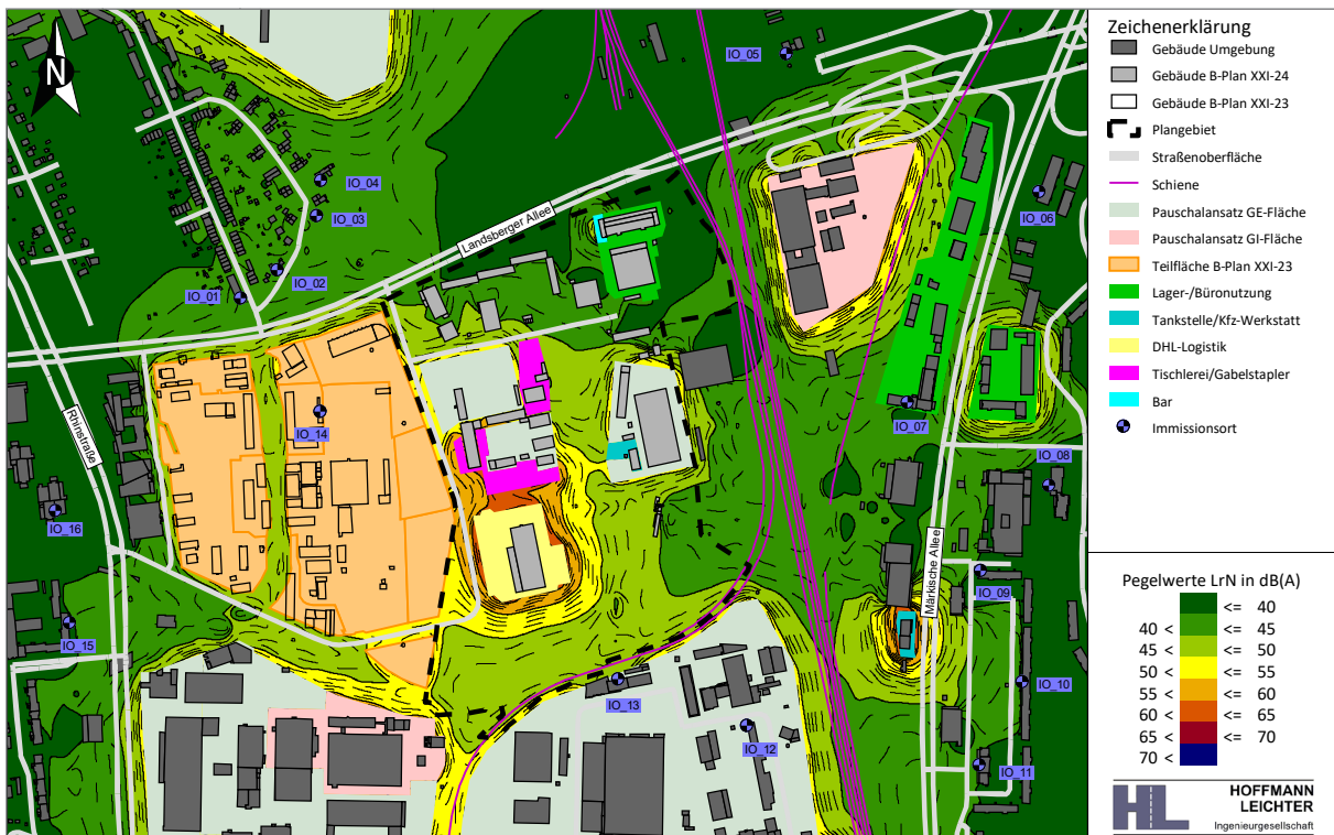
Abbildung 5-6 Isophonenkarte in 5 m Höhe über Gelände | Beurteilung nach TA Lärm | Gesamtbelastung | nachts, 22:00 - 06:00 Uhr
