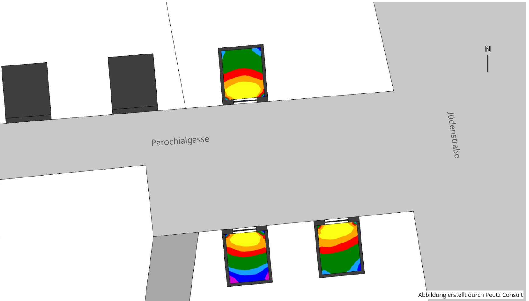
Grundrissdarstellung Teilbereich 1.2 – 1. Obergeschoss Fehlfarbendarstellung des Tageslichtquotienten
