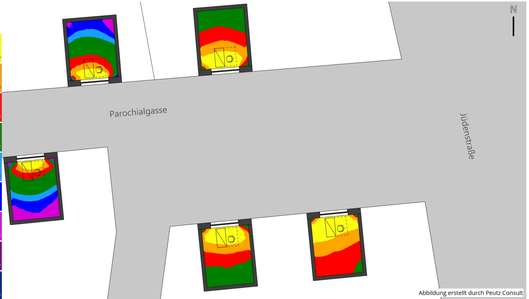
Grundrissdarstellung Teilbereich 1.2 – Erdgeschoss Fehlfarbandarstellung des Tageslichtquotienten
