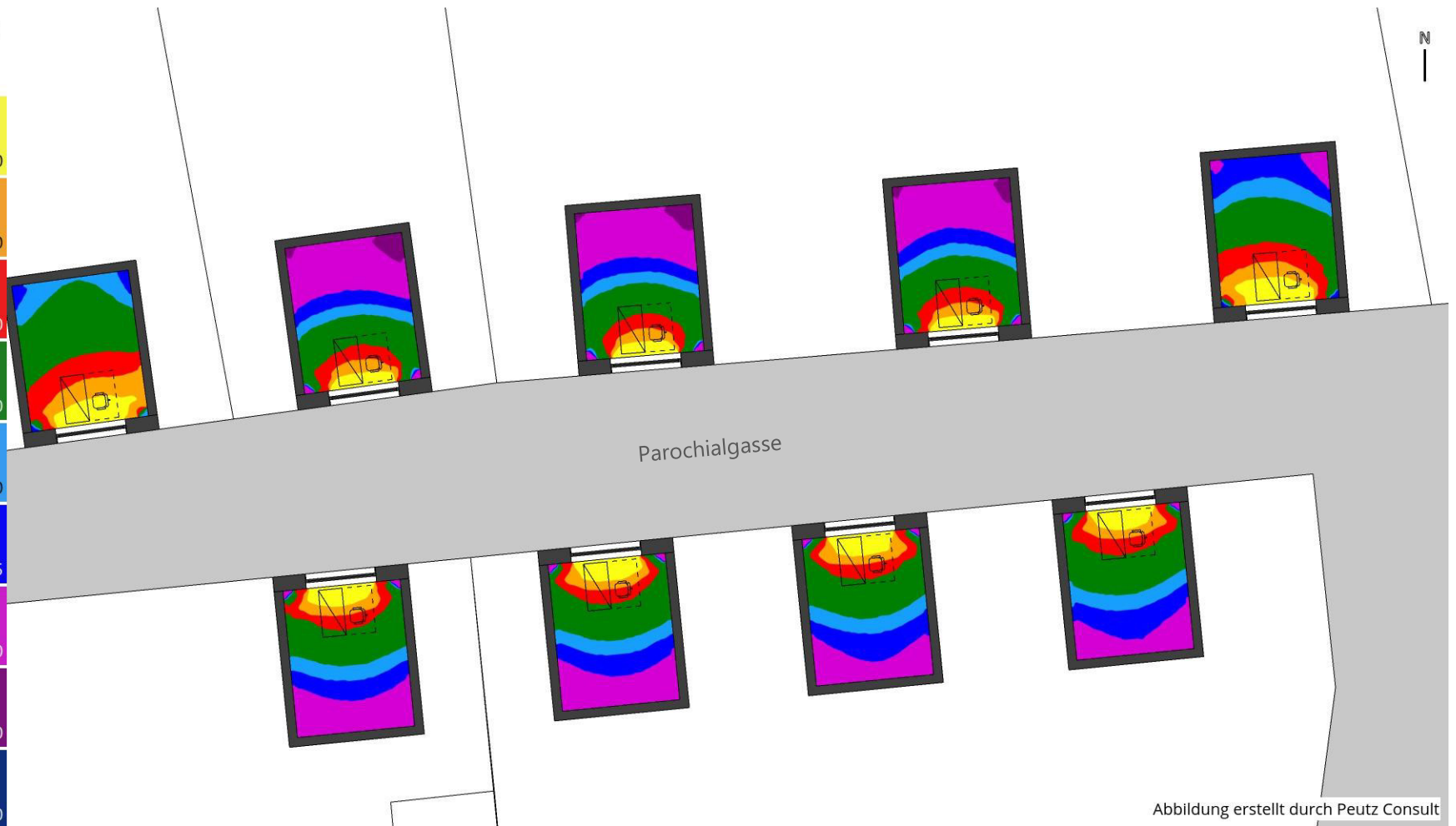
Grundrissdarstellung Teilbereich 1.1 – Erdgeschoss Fehlfarbendarstellung des Tageslichtquotienten
