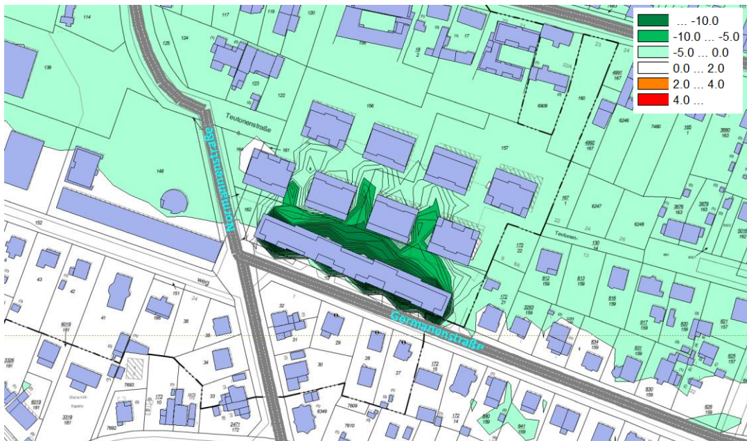
Abb. 6.3: Einfluss des geplanten Baukörpers auf die Verkehrslärmbelastung des Bestands, Pegelunterschied Planfall - Nullfall
